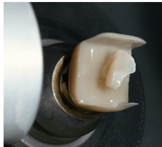
c : イニシャル LiSi ブロック A2 HT (ジーシー) を選択し、CEREC MC-XL (デンツプライシロナ) を用いてミリング。約10分の時間を要した
