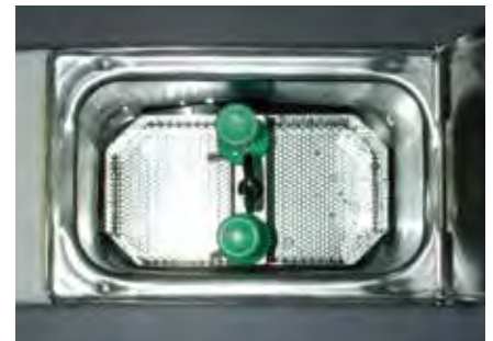
100℃の煮沸水で5～10分間ボイリングします。ボイリング後は恒温槽60～63℃の温水中に保存します。
