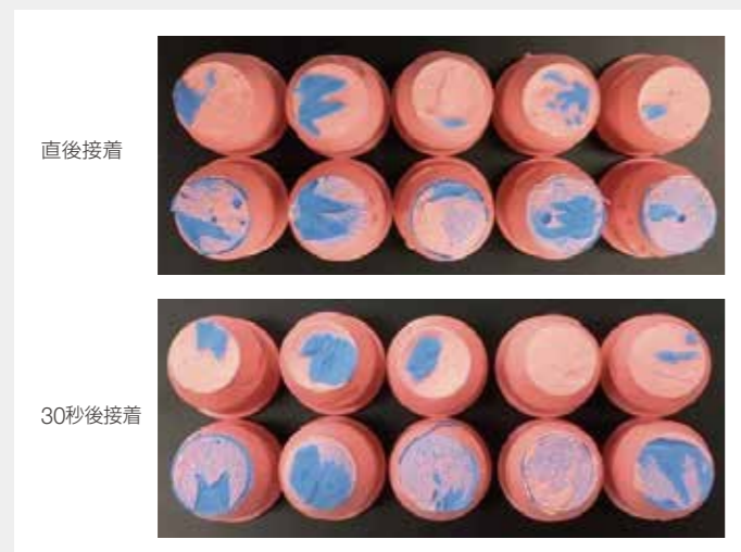
図5-1 接着試験後の破断面 (精密印象材:ARI、ベースアルジネート印象材:AFP)
