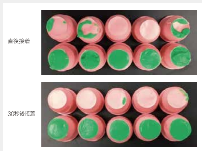
図5-2 接着試験後の破断面 (精密印象材:ARL、ベースアルジネート印象材:AFP)
