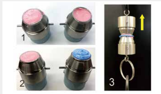
図3 JIS T 6512:2016(寒天印象材)7.7引張接着強さ試験に準じた評価
