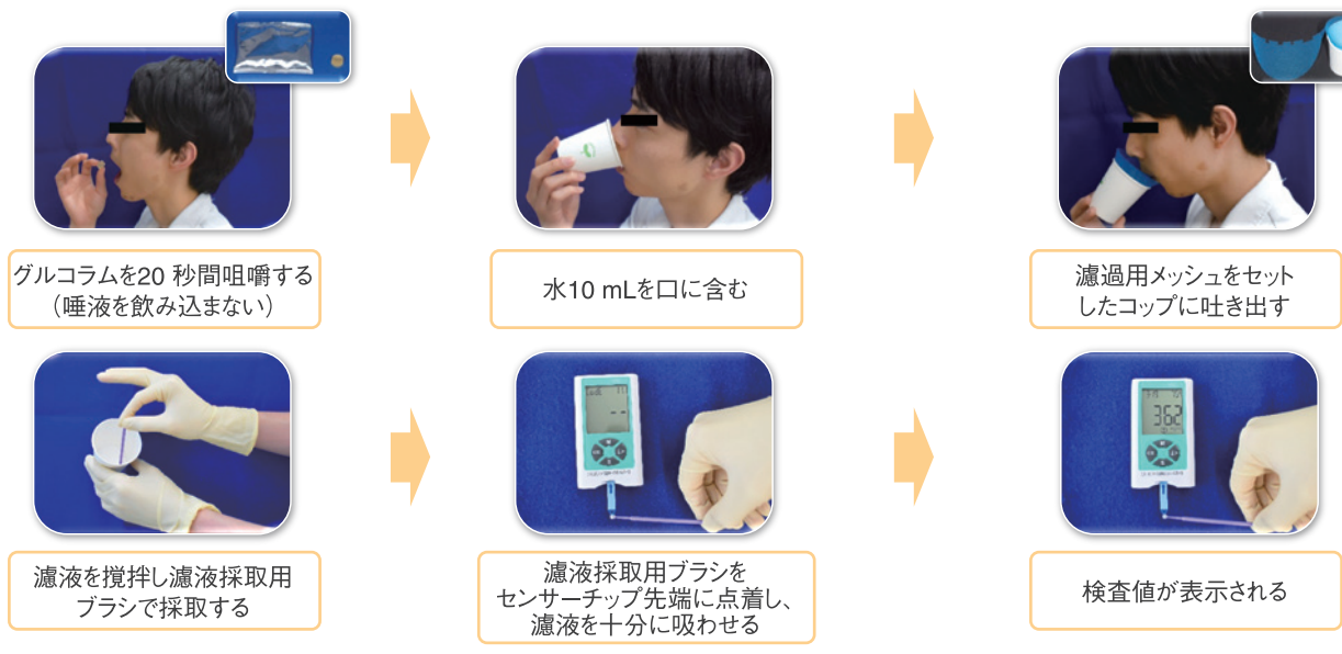
図3 グルコラムとグルコセンサー(ジーシー グルコセンサー GSI)を用いた咀嚼能力測定
