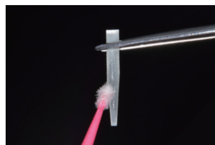
2-4-4 直接法においても、ポスト材へシランカップリング処理を確実に。
