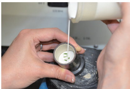
2-16 埋没する前にワックスパターンにシュールミストを噴霧して、よく乾燥させる。リングライニング材は、「バイオキャストイングライナー」を使用し、内面や隅角など、細部に気泡が入らないようにコーティングを行った後、「クリストクイックⅢ SF」を素早くリング内に流し込む。注意点として、埋没時に長時間パイプレーターをかけると部分的に混水比が変わる恐れがあるので、必要最低限の使用にとどめる。硬化後、「クリストクイックⅢ SF」の通気性をよくすることを含めて、余剰の埋没材を平面に整える。
