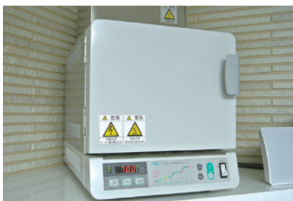
2-18 リングを700°Cに設定した「オートファーンেসMF-I」に入れ、30分以上係留してワックスが焼却した後、鑄造を行う。700度に設定しても、実際にその温度に達していないファーンেসもあるので注意する。
