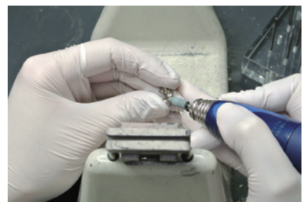
2-20 スプルー線をカッティングディスクでカットした後、通法どおり研磨する。
