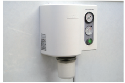
2-15 20秒間むらなく均一に手練りした後、「バキュームミキサーVM-II」を用いて40秒間の真空練和を行う。
