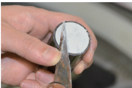
2-16 埋没する前にワックスパターンにシュールミストを噴霧して、よく乾燥させる。リングライニング材は、「バイオキャストイングライナー」を使用し、内面や隅角など、細部に気泡が入らないようにコーティングを行った後、「クリストクイックⅢ SF」を素早くリング内に流し込む。注意点として、埋没時に長時間パイプレーターをかけると部分的に混水比が変わる恐れがあるので、必要最低限の使用にとどめる。硬化後、「クリストクイックⅢ SF」の通気性をよくすることを含めて、余剰の埋没材を平面に整える。
