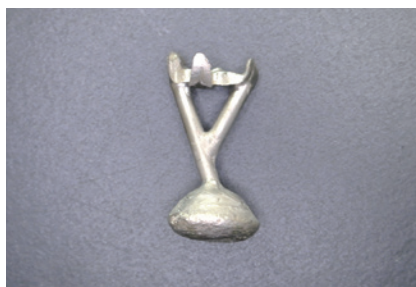
2-19 掘り出し後、酸処理を行い、サンドブラスターをかける。
