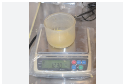
2-7 「ニュープラストーンII LE」を、標準混水比0.23(粉末100gに対し水23mL)で正確に計測する。
