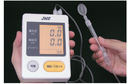
3-6 JMS舌圧測定器。日本国内初の舌圧測定器として医療機器承認を取得した。
