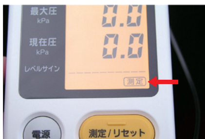
4-1 電源投入後、「測定/リセット」ボタンを押すと自動で舌圧プローブが加圧され、最大圧と現在圧がリセット、測定のアイコン(矢印部分)が表示される。
