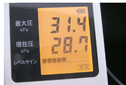
4-3 測定時は、バルーン部に加わる圧力が現在圧としてリアルタイムで表示され、測定中の最大値がその上段に「測定/リセット」ボタンを押すまで表示される。
