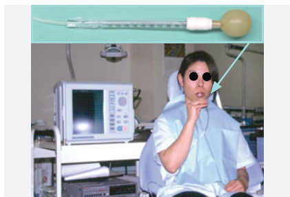
2-1 開発初期の舌圧測定装置(Hayashi et al., 2002)。装置は一般工業用で大型のため、測定環境が限定され、結果の即時算出も困難だった。
