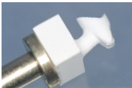
24 削り出されたインセラムフレーム。鋭利なマージン形態ではチップする場合もある。
