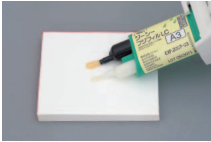
1 4 フジフィルLCのペーストをCDカートリッジから取り出し、しっかり練和する。
