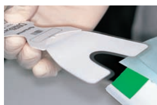
2-2 デンタルプレスケールのペーパーホルダー部を持ち、ゆっくりと包装から取り出す。このとき、プレスケールシートを折り曲げないように注意する。
