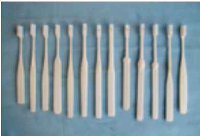
1. 開発プロセスモデル1…ラフアイデア展開 ラフな考え方のわかる、発泡材の削り出しによる形状モデル。
