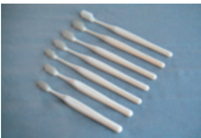
7. 開発プロセスモデル7…試作型による確認 すべてのタイプの仮型を製作し、デザイン図面にもとづき、植毛孔を形成し、植毛試験を行います。植毛孔の位置はぎりぎりまで端へチャレンジしました。また、出来上がった試作品は開発担当者が、各方面で使用試験を行い、毛の硬さや長さを先生方の指導のもとに決定していきます。
