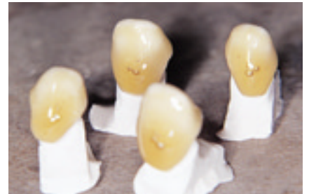
35 ガラスが浸透するにつれて毛細管現象によってアルミナ結晶粒子間の隙間に浸透する。ガラス浸透焼成完了後のコアフレーム。
