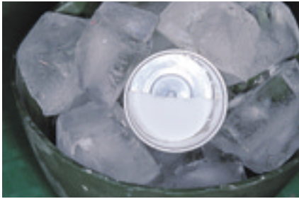
14 スリップ築盛時はラバーボールに氷を入れ冷却しながら流動性を保つ。
