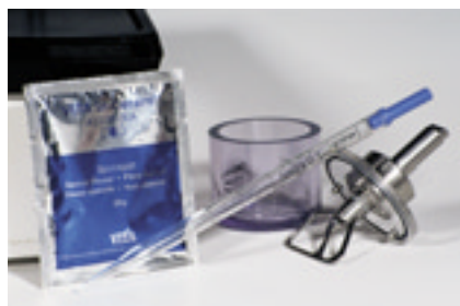
10 ビタインセラム スペシャルプラスター模型の作製。(W/P 粉10g: 蒸留水2.3mL) 注入後2時間放置し硬化させる。
