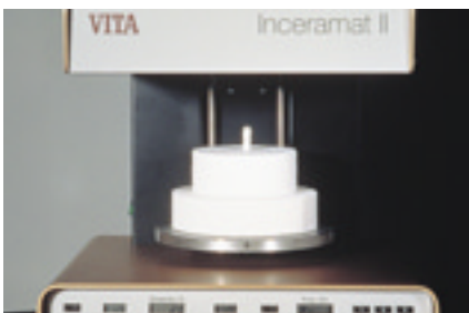
23 ビタインセラムIIにて右表の焼成スケジュールにより焼結焼成する。
