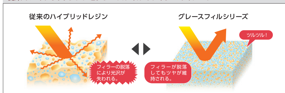
図E グレースフィルはナノサイズの多角形フィラーが均一に分散しているため、摩耗によるフィラーの脱落が起こりにくく、脱落しても表面の凹凸が極めて小さいため艶を長期維持できる。また、研磨が行き届かない部位でも、日々のブラッシングによってレジン面の凹凸がナノフィラーサイズまでならされて艶を生み出す効果（セルフシャイニング効果）も備えている。
