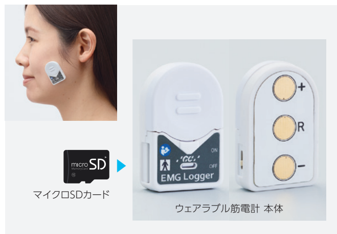
図2 ジーシーが発売したウェアラブル筋電計。
