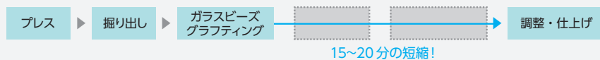
図8 イニシャル LiSi プレスのステップは、危険を伴うフッ酸処理が不要で、15~20分の時間短縮にもなる。またフッ酸廃液が生じないため、環境にも優しいシステム。
