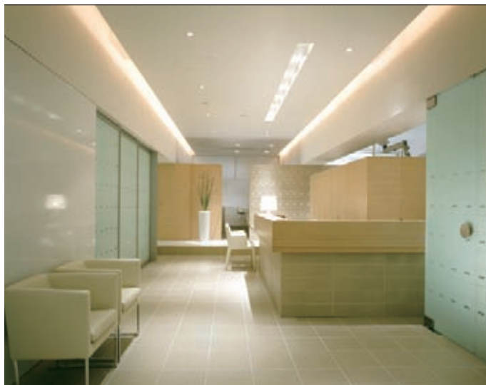
図13 入口ホールより全体を見る。天井には、高さ1mの大梁がある。その側面にスリットをつくり、光を配したことで天井高を想像させるデザインに。
