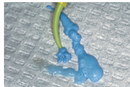
2-3 使い始めに確認された透明なペースト(基材)とミキシングされた印象材の状態を示す。使用マニュアルでは使用前にカートリッジの先端で、必ず、すり切りを行うように指示している。
