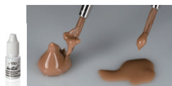
図F リキッドの違いにより粘性が変わることがわかる。左:グレースペーストリキッド、右:グレースリキッドによる混和。
