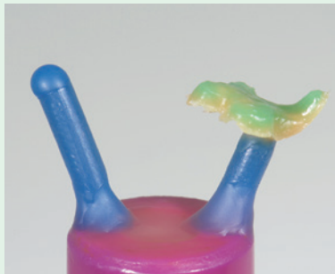
2-2 従来通りワックスアップを行いLiSi プレスベストにて埋没し、プレス工程に進んでいく。LiSi プレスは反応層が少なく、サンドブラスターにて2気圧のガラスビーズにて簡単に埋没材からの割り出しができる（本ケースはIn-Mにてプレス）。
