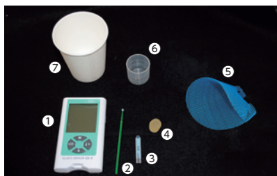
3-1 準備するもの(①グルコセンサーGS-II、②採取用ブラシ、③GS-IIセンサーチップ、④グルコラム、⑤ろ過用メッシュ、⑥計量カップ、⑦コップ)。
