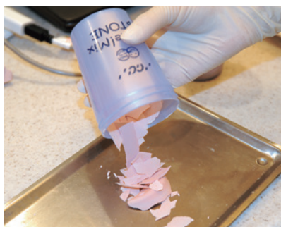
図3 ボトルに残った石こうは、硬化後に専用シェイカーを握って変形させることで、簡単に取り出すことができる。後は軽く水洗いで清掃が完了する。
