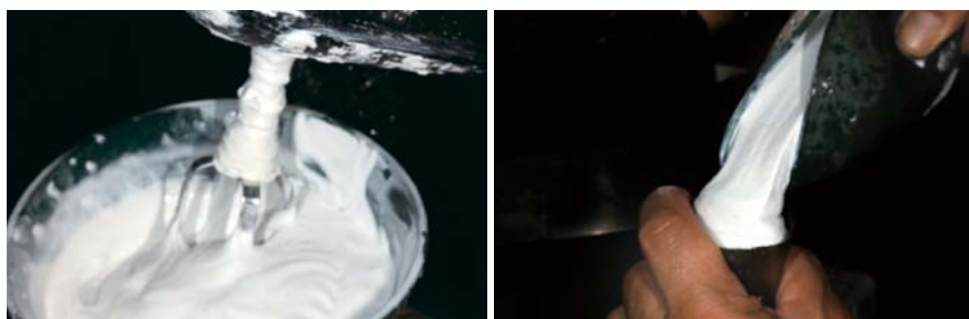
33、34 最終の外埋没となる普通石膏を家庭用ミキサーにて練和している。ここで、流動性をよくするため、混水比をあまり多くしてはいけない。通常の泥状で、流し込むことが、のちに精度を保証する部分である。
