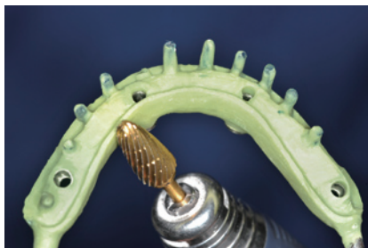
10-2 CAD/CAMによるフレームワークのパターンの整形に際しても、その切削性の良否は作業能率に大きく影響する。(資料:リアリティ・デンタル・ラボラトリー 歯科技工士 鶴澤 忍氏のご厚意による)
