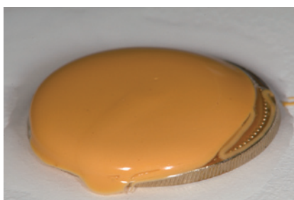
1-2 無圧のまま硬化させた状態。流動性がもっとも高いタイプであるが垂れぐあいは中程度であり、ある程度の保形性を有していることがわかる。
