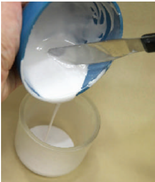
5-7 ラバーボールで練和後、真空練和器 のカップに移し真空練和器にかける。 こうすることで埋没材が均一に練和できる。
