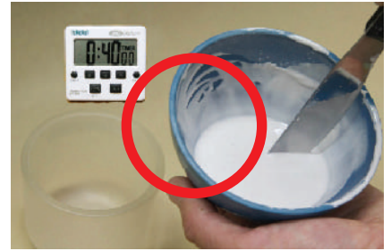
5-6 イノベストは流動性が良いため、感 覚だけに頼ると練和時間が短くなり やすい。そのためにタイマー等で練和時間を 計測しておくことを勧める。
