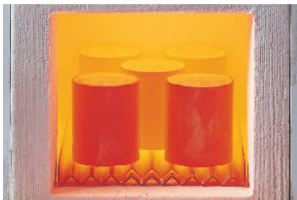
5-10 リングファーネスへの投入 イノベストは従来通り埋没後20分以 降であれば、いつでもファーネスに投入するこ とができる。 焼却をしっかりと行うことで鑄造時にあられる 欠陥を減少させることができる。
