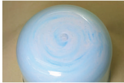
5-5 練和水を着色し、練和後、カップの 裏から見ると混ざり切れていない埋 没材を観察できる。こういったことからカップ で直接練ることは避けたい。
