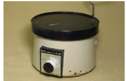
5-9 パイブレーターは大型のほうが自重 で安定し、パイブレーションがよく伝 わる。また小型のものに比べ耐久性も高い。 写真はジーシー社のパイブレーターR-IIで、今 は残念ながら製造されていない。
