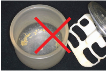
5-4 バキュームミキサーによる練和 練和の際、真空練和器のカップ内で スパチュラを使って練らない。これは底にある 粉がカップが堅いためぎっちり練ることが できないからである。 また練和の際カップを傷つけ埋没材がこびり ついてしまうことになる。
