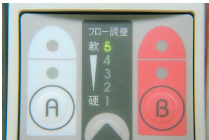
5 4 寒天が押し流される恐れがある場合、フロー5(軟)を選択する。
