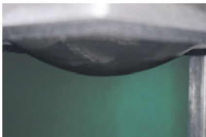
4. インパクトガードが2cmほど垂れ下がり、軟化状態になったらバキュームを作動させ、成形器のフレームのハンドルを下げても型に覆い被せる。この時インパクトガードの軟化が過度にならないよう注意が必要である。
