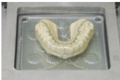
5. 2分程度の吸引による冷却を行い、模型と一緒に取り出します。
