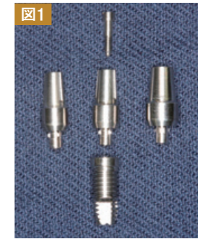
図1 実験に使用したインプラントとアバットメント アバットメントの直径は、左から3.7mm、4.2mm、5.0mm。
